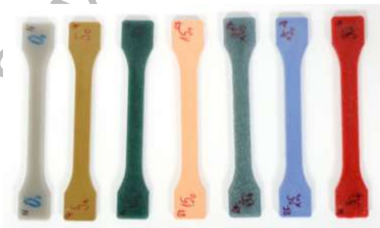
Слика 2. Обрађене епрувете основног материјала и материјала са додатком: 5%, 10%, 15%, 20%, 25% и 30% стакленог праха
